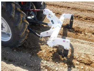
写真5 サブソイラ施工の様子
