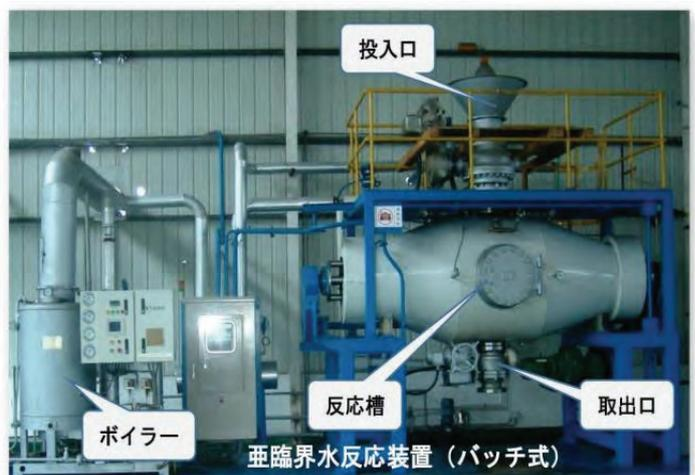
図-2 （株）エースクリーンが所有する亜臨界水反応装置（G-8 International Trading（株））。亜臨界水技術とは水の臨界点（374℃・218気圧）以下の亜臨界水領域の高温・高圧の飽和水蒸気の強力な加水分解力を利用する技術で、本装置は実用的な100-200℃・10-20気圧で多様なバイオマス（廃棄物）を処理、堆肥や肥料、アミノ酸・フルボ酸などに展開しうる汎用的な小型のバッチ式装置として開発された。
